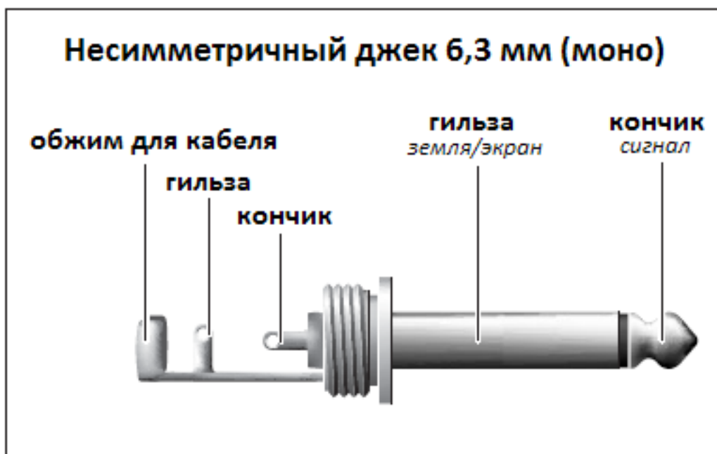
Рис. 3.2 Назначение контактов у моно-джека 6,3 мм
